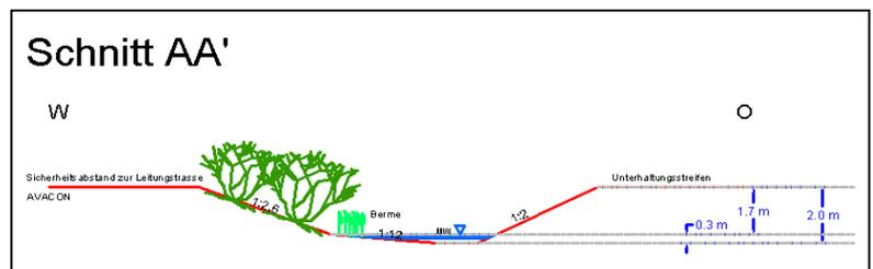
In Zusammenarbeit mit dem Ingenieurbüro BPR, Hannover, das die technische und hydraulische Planung bearbeitete, entstand der Entwurf eines Gewässerbettes mit Bermen, Flachwasserbereichen und begleitenden Gehölz- und Schilfpflanzungen. Er diente als Grundlage für die Eingriffsbeurteilung und wurde Bestandteil der Genehmigungsunterlagen gem. §119 NWG.
