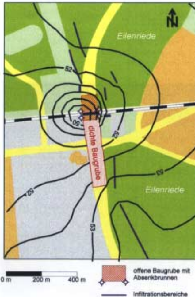
Abbildung 7. Grundwasser ganglinien für einen Zeitpunkt aus der ersten Absenkungsphase (in mNN).
